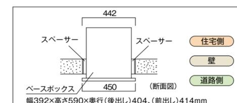
●ヴィコDB(スペーサー付)には、ベースボックスに取り付けていただくスペーサーが付属されており、幅450mmサイズの組積材に設置する際に使用します。
