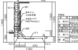
擁壁高さ:2,020mm 必要地耐力:95KN/m 2 断面図:L1-350-09
